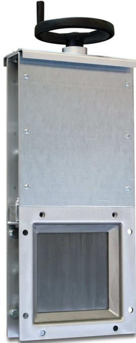
Der **Flachschieber TYP SMFS** wird an Silo- und Behälterausläufen eingesetzt. Er garantiert optimale Abdichtung bei Lagerung von staubhaltigen oder granulaförmigen Schüttgütern bis 8 mm Korngröße. Die Ausführung „Handschieber“ dient als Not-Absperrschieber. Der modular aufgebaute Schieber ermöglicht bei gleichem Grundrahmen den Anbau der verschiedenen Antriebsarten Hand-, Pneumatik- und Elektromotorischen Antrieb.
