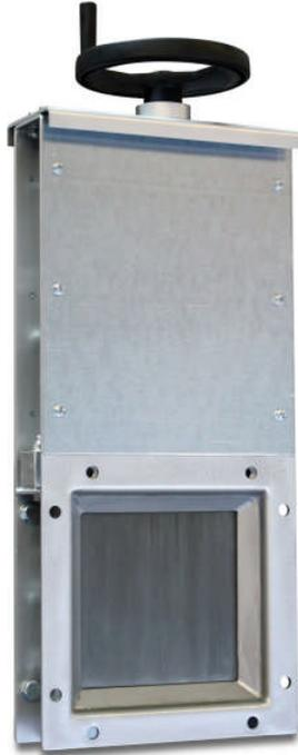
Der **Flachschieber TYP SMFS** wird an Silo- und Behälterausläufen eingesetzt. Er garantiert optimale Abdichtung bei Lagerung von staubhaltigen oder granulatformigen Schüttgütern bis 8 mm Korngröße. Die Ausführung „Handschieber“ dient als Not-Absperrschieber. Der modular aufgebaute Schieber ermöglicht bei gleichem Grundrahmen den Anbau der verschiedenen Antriebsarten Hand-, Pneumatik- und Elektromotorischen Antrieb.
