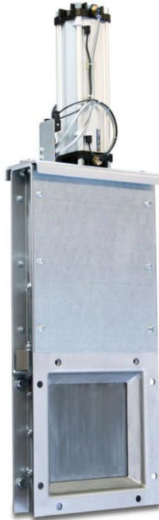
Der **Flachschieber TYP SMFS** wird an Silo- und Behälterausläufen eingesetzt. Er garantiert optimale Abdichtung bei Lagerung von staubhaltigen oder granulatförmigen Schüttgütern bis 8 mm Korngröße. Die Ausführung „Pneumatikschieber“ dient als Dosierschieber. Der modular aufgebaute Schieber ermöglicht bei gleichem Grundrahmen den Anbau der verschiedenen Antriebsarten Hand-, Pneumatik- und Elektromotorischen Antrieb.
