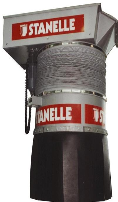
Die Belader Typ Rondo DN 350, 500 ist ein Spezialbelader, zur Beladung von pulverigen bis feinkörnigen Schüttgütern, wie z.B. Gesteinsmehl, Kies, oder Splitt auf offene LKW oder Bahnwagons.
