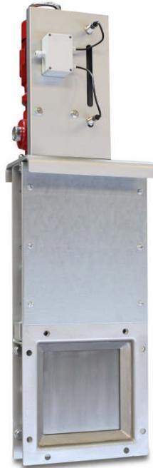
Der **Flachschieber TYP SMFS** wird an Silo- und Behälterausläufen eingesetzt. Er garantiert optimale Abdichtung bei Lagerung von staubhaltigen oder granulaförmigen Schüttgütern bis 8 mm Korngröße. Der modular aufgebaute Schieber ermöglicht bei gleichem Grundrahmen den Anbau der verschiedenen Antriebsarten Hand-, Pneumatik- und Elektromotorischen Antrieb.
